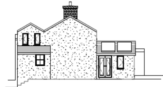
EDRYCHJAD OCHR EXISTING SIDE ELEVATION
